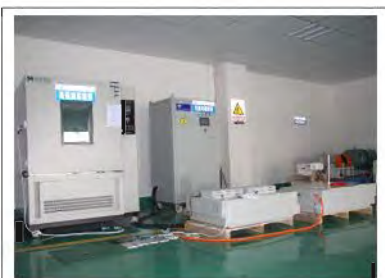
电池PACK充放电实验及高低温实验测试平台
