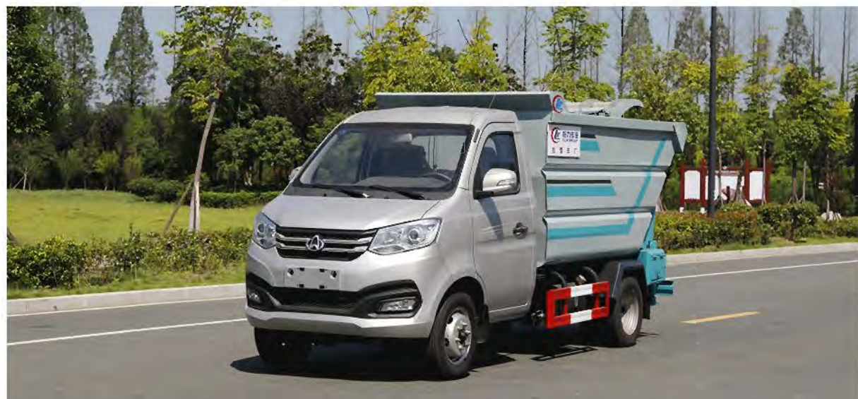
长安无泄露自装卸式垃圾车
