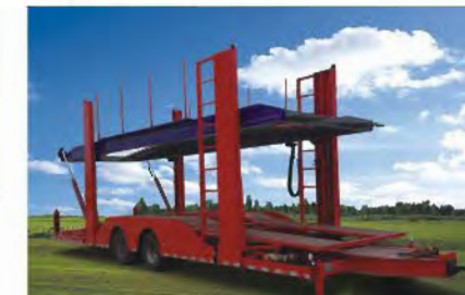
程力CLW9150TCL5型车辆运输车 额定载质量: 15000kg, 轴距: 6000+1350mm 此车型由工程车厂生产
