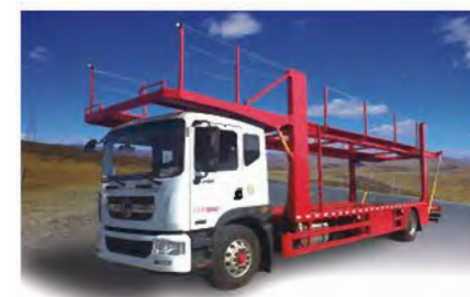
程力CLW5182TCL5型车辆运输车 额定载质量: 8005kg, 轴距: 7160mm 此车型由工程车厂生产
