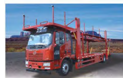
程力CLW5160TCLC5型车辆运输车 额定载质量: 6005kg, 轴距: 7100mm 此车型由工程车厂生产
