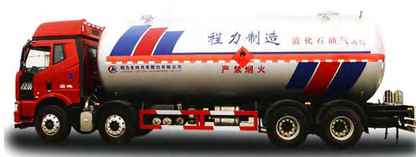
37.2立方丙烷运输车（解放8×4底盘）：装载质量为15624Kg，整备质量为16246Kg，罐体材质为Q370R。
