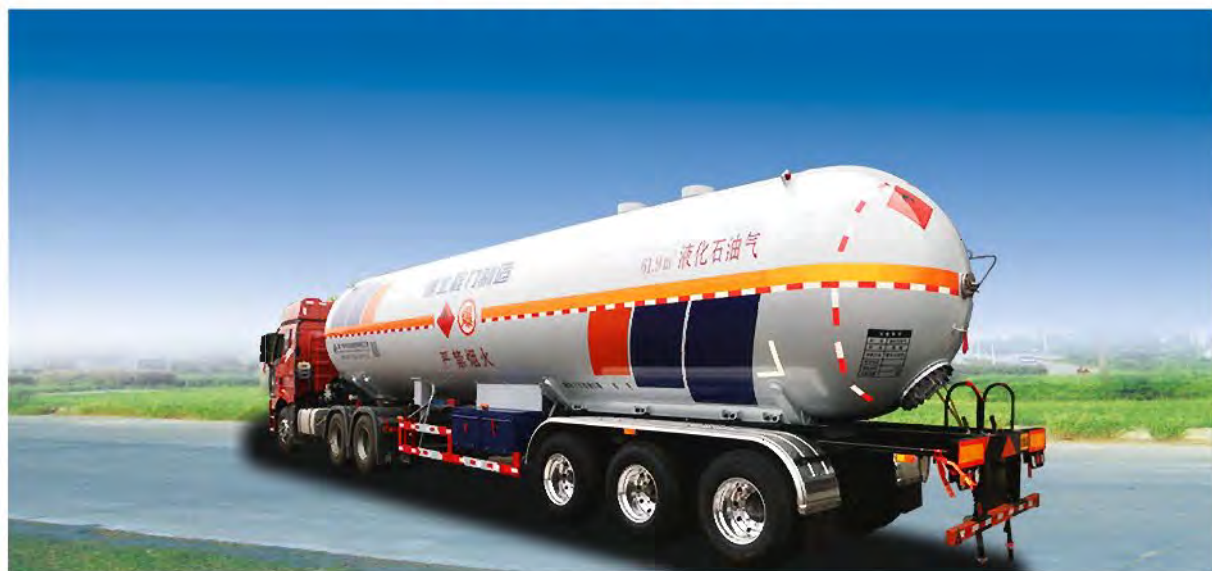
液化气体运输半挂车：丙烷、液氨、丙烯、丁烷、异丁烷、异丁烯、丁二烯、二甲醚、二氧化硫、三氯硅烷等介质。
