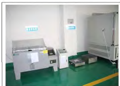
零部件盐雾实验测试平台
