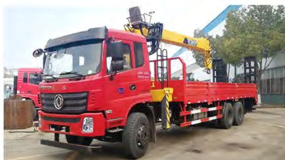
东风后双桥8吨四节臂随车吊
