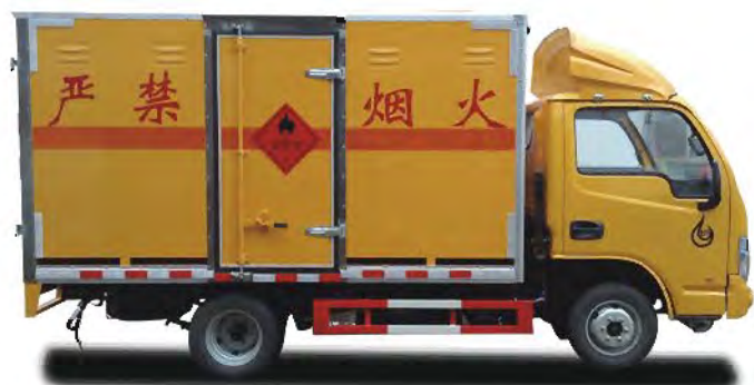
气瓶运输车用于运输具有独立容器（瓶）包装的：液化石油气、丁烷、丙烷、打火机或打火机加油器、压缩氧、溶解乙炔、压缩甲烷或甲烷含量高的压缩天然气。
